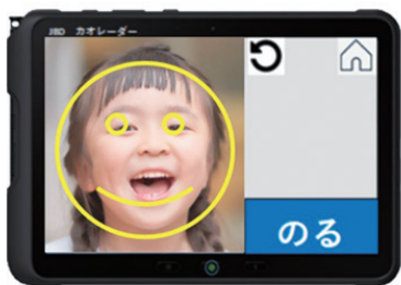
わずか0.2秒で顔写真と乗降データがタブレット内に記録される
